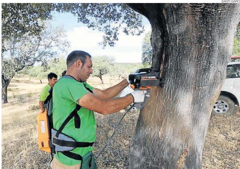
►► **Ensayo** ► Prueba de la nueva herramienta para la extracción del corcho, en junio pasado.
